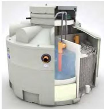
L'ensemble de nos micro-stations utilise la **technologie du lit fixe immergé aéré**, réputée comme la technologie ayant les rendements épuratoires les plus stables, et ne nécessitant qu'un minimum d'entretien. Le système fonctionne grâce aux bactéries qui se développent sur le bioblok qui offre une grande surface de contact entre la biomasse, l'oxygène et l'eau usée, tout en optimisant le processus d'aération.
