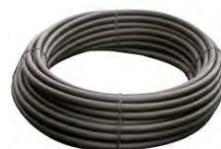
Tuyau à goutteurs intégrés de diamètre 6 mm intérieur à utiliser pour les zones très petites et étroites (ex : jardinières). Espacements de 0,15 m. Débit 2 l/H. Pression maximum 3,5 bars.
