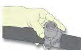
Assemblage des 2 parties du collier autour du tuyau, pose des vis de fixation et serrage.
