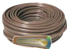
Il se présente sous la forme de goutteurs autorégulants et autonettoyants intégrés dans un tube de 16 mm de diamètre intérieur. Espacements de 0,30 m. Débit 1,6 L/H. Plage de pression : 0,5 à 2,5 bars.
